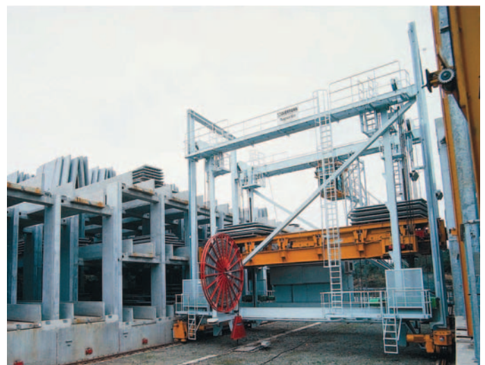
2 Das Regalbediengerät hat eine Tragfähigkeit von 50 t
